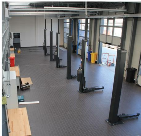
**5| Insgesamt sieben Bühnen:** In der Werkstatt sind fünf Pkw-Bühnen verbaut, dazu kommt eine für Transporter sowie noch eine Scherenbühne für spezielle Arbeiten (SEP, TÜV, Achsvermessung).
